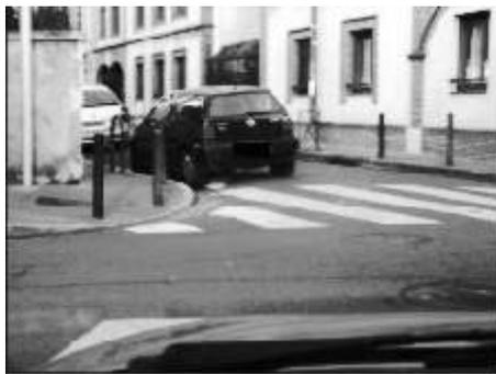
Ces véhicules masquent les cyclistes qui arrivent dans l'autre sens. L'installation de plots au sol pour doubler le zébra permettrait de dégager des cônes de visibilité et d'améliorer la sécurité des cyclistes.
